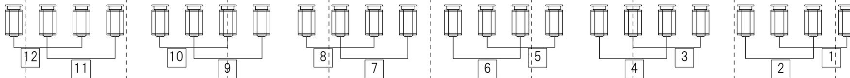
直回路 30A・C型×2回路 15A・平行×2口 (同一回路 最大20A)
